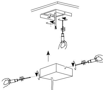
1. Positionner les vis de maintien au plafond et positionner les filins acier
