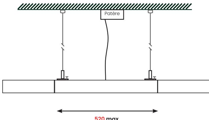
**Installation des accessoires de maintien et filin de suspension**
